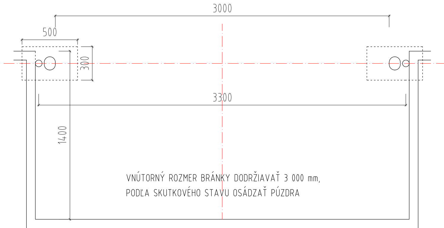
DETAIL OSADENIA FUTBALOVEJ BRÁNKY M 1:20
